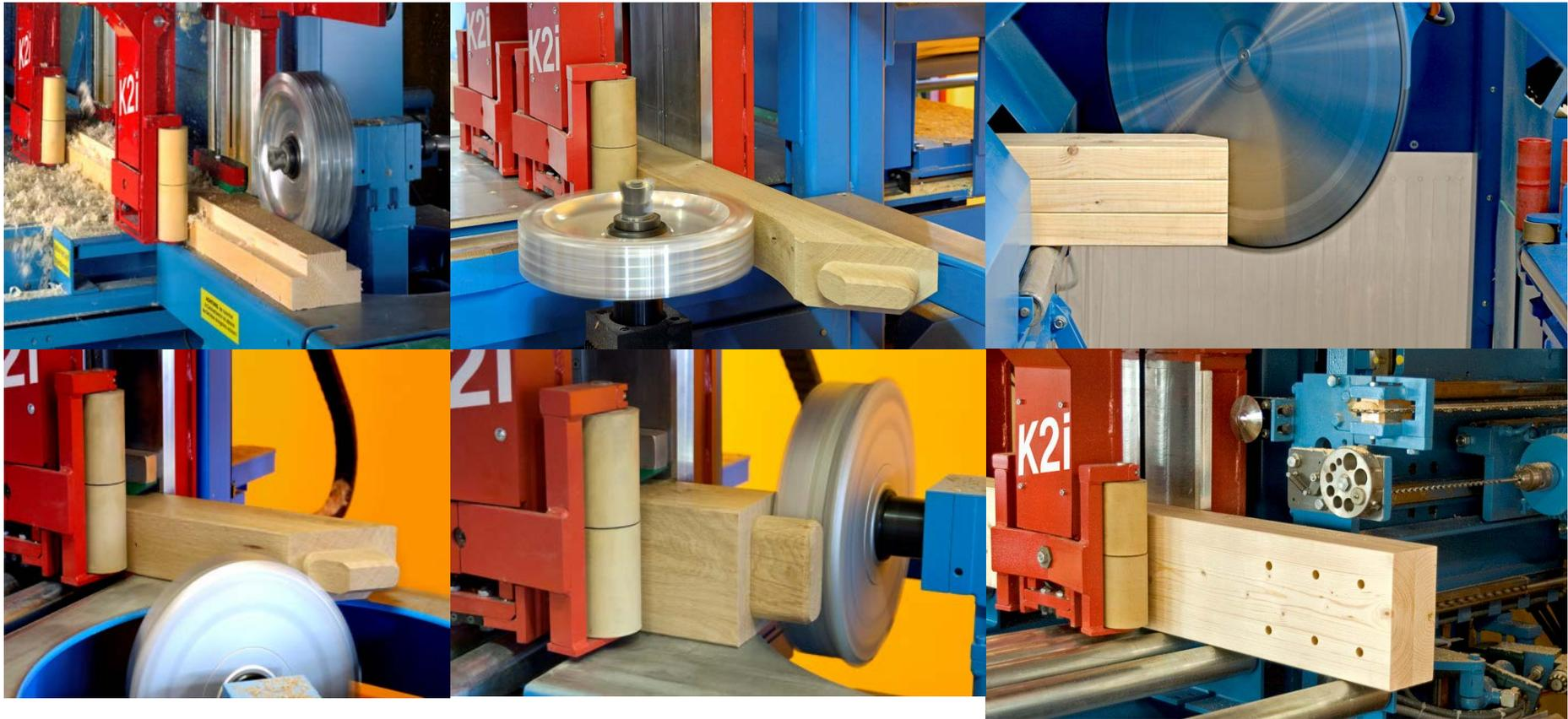
Herstellung der Holzrahmenbauelemente in einer 25x60 m großen überdachten und beheizten Halle auf CNC gesteuerter Nagelbrücke. Höchste Präzision und innovative Technik gepaart mit handwerklichem Können und Zimmerertradition sichern allerhöchste Qualität in der Ausführung
